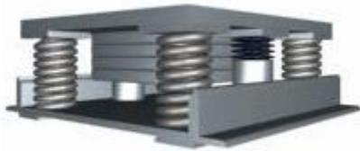
Figura 3.6 – Amortecedor de massa sintonizado (HENRIQUES *et. al.*, 2013).
