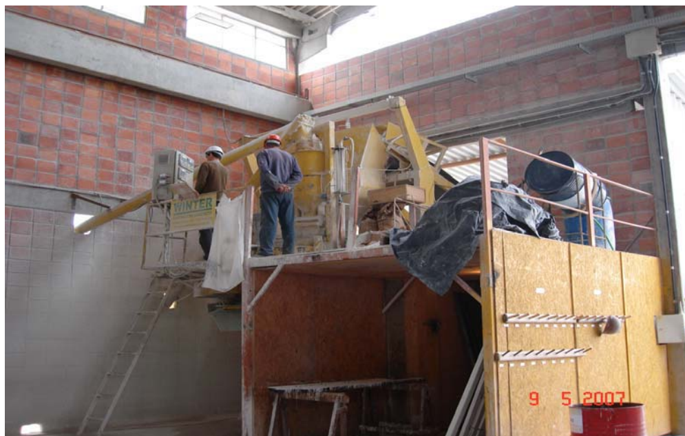
Figura 81 – Controle tecnológico na fábrica na mistura dos materiais na concretagem
