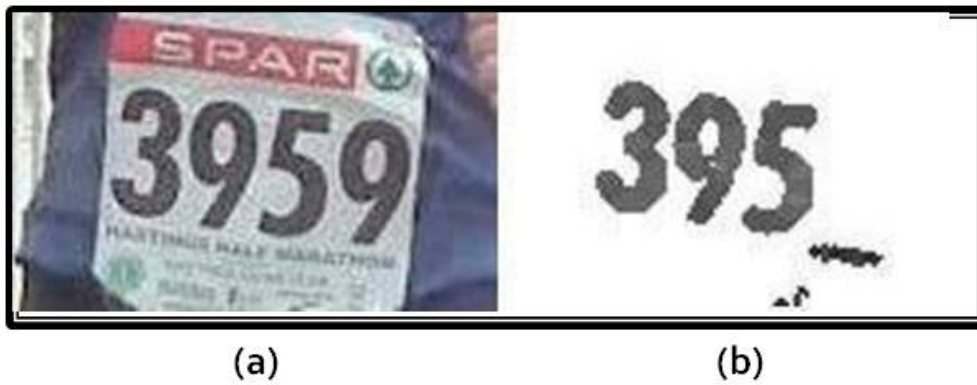
Figura 2.2: No exemplo, (a) mostra uma imagem obtida de [Ben-Ami, Basha e Avidan 2012] e em (b) o resultado após execução do algoritmo de [Epshtein, Ofek e Wexler 2010]. Verifica-se em (b) que o último número(9) foi perdido e houve a detecção de outros componentes fora da região dos números.
