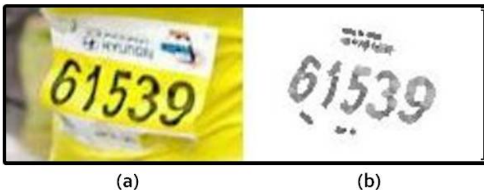
Figura 2.4: No exemplo, (a) mostra uma imagem obtida de [Ben-Ami, Basha e Avidan 2012] e em (b) o resultado após execução do algoritmo de [Epshtein, Ofek e Wexler 2010]. Verifica-se em (b) que todos os números foram detectados mas também houve a detecção de outros componentes fora da região dos números.
