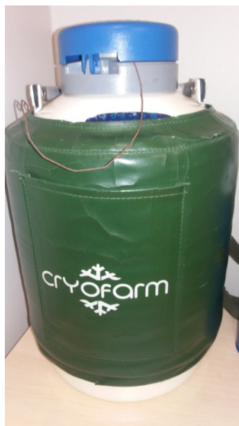
Figura 3.10– Dewar com nitrogênio líquido, para tratamento criogênico profundo.
