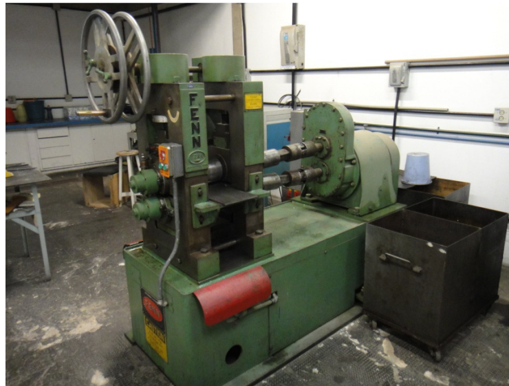
Figura 3.7– Laminador FENN para laminação à quente do lingote.
