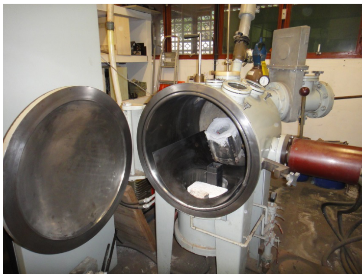
Figura 3.2– Forno de indução eletromagnética de alta frequência INDUCTOTHERM com cadinho de carbeto de silício.
