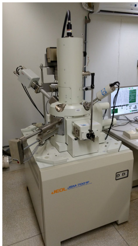
Figura 3.19– Microscópio eletrônico de varredura JEOL JSM-7001F.
