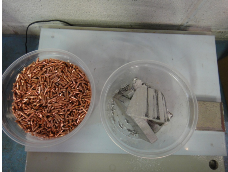
Figura 3.3– Matéria-prima para a fusão – cobre granulado, alumínio e níquel em barras.
