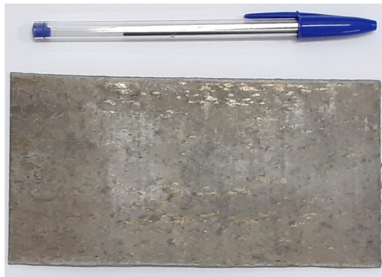
Figura 3.8– Placa obtida após laminação.
