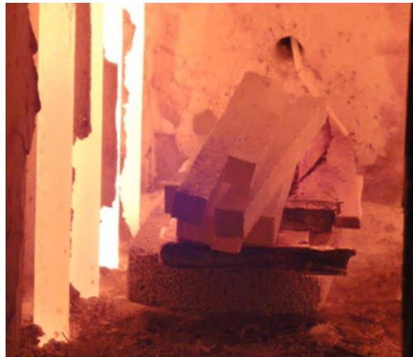
Figura 3.6– Processo de homogeneização, em forno mufla.
