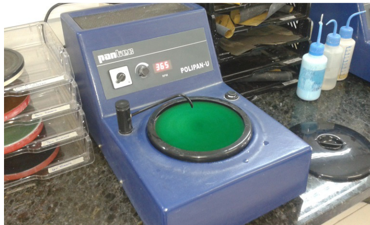
Figura 3.13– Politrizes semi-automática Pantec Polipan-U.
