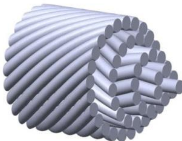
Figura 3: Desenho esquemático de um cabo condutor mostrando as camadas concêntricas.
