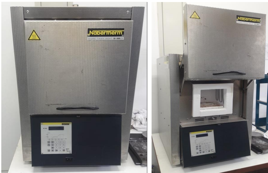
Figura 43: Forno Nabertherm com controlador P310 utilizado para os tratamentos térmicos dos fios.
