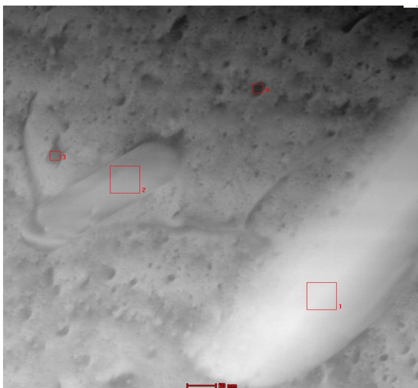
Figura 74: Imagem para análise em EDS dos possíveis precipitados de Mg-Si e precipitados de Fe da amostra apenas solubilizada a 550°C (S5E0).
