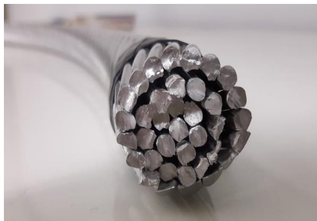
Figura 36: Cabo comercial da liga 6201 composto por fios dispostos concentricamente ao fio central.
