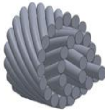
Figura 35: Representação esquemática dos fios dispostos concentricamente ao fio central. Fonte: Reinke (2017).
