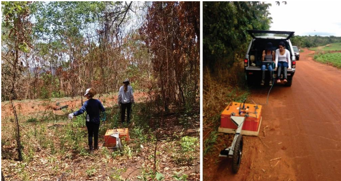
Figura 4-2: Fotos evidenciam a aquisição de dados de GPR com o equipamento SIR-3000 acoplado a uma antena blindada de 200 MHz, no interior e nos arredores do Lixão de Pirenópolis/GO.
