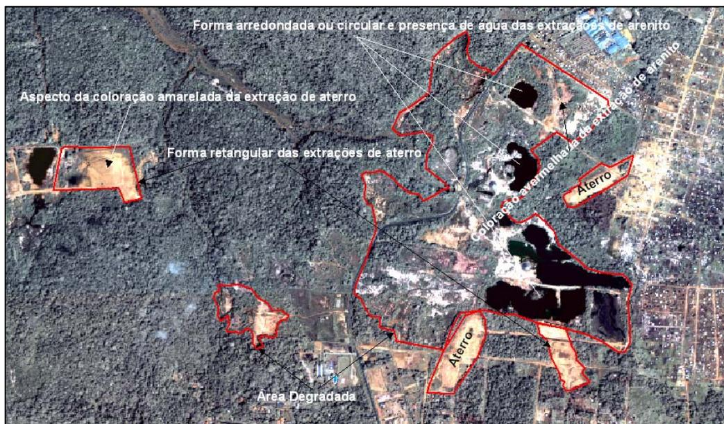
**Figura 5.9.** Fatores de identificação do padrão morfológico de degradação pela mineração de acordo com o tipo mineral explorado(arenito e aterro). Imagem Quickbird 2003 no Bairro Tarumã.
