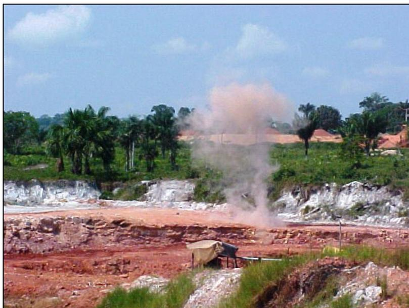
**Figura 5.4.** Exemplo de extração de arenito ativa, após detonação, km 15 da BR 174, Ramal Chico Mete Marcha, visitado no levantamento de campo (Ponto 29 do Anexo D) (Foto com data anterior ao levantamento).
