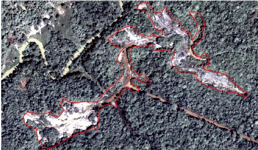
**Figura 5.11.** Padrão alongado da morfologia da degradação causada por antiga extração de areia (imagem Quickbird 2003) no Bairro Tarumã.
