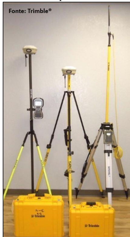
Figura 2.11 GNSS RTK representado por rover e estação base (Trimble)
