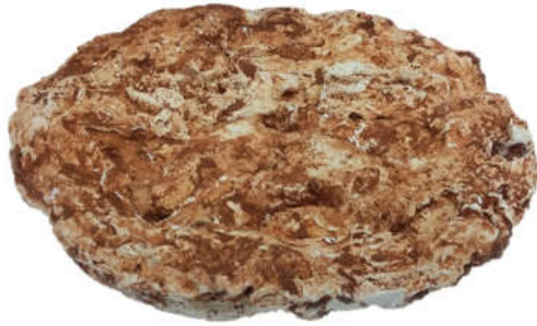
Figura 4.16. Penetração dos grãos de brita moldada com gesso no ensaio C(24)-SG.
