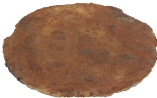
Figura 4.20. Penetração dos grãos de brita moldada com parafina no ensaio C(24)-900 -2° ensaio.
