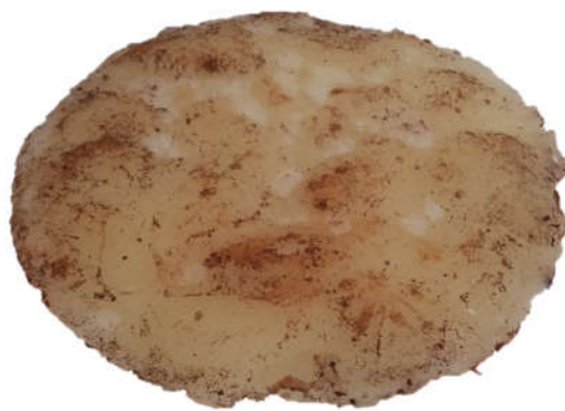
Figura 4.19. Penetração dos grãos de brita moldada com parafina no ensaio C(24)-900 -1° ensaio.
