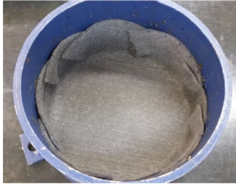
Figura 3.40. Cortes nas amostras de geotêxtil para que essas ficassem moldadas ao cilindro.
