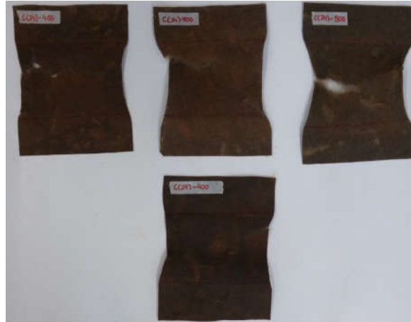
Figura 4.32. Geotêxteis após rompimento na prensa de tração (corpos de prova submetidos aos ensaios de carregamento cíclico).
