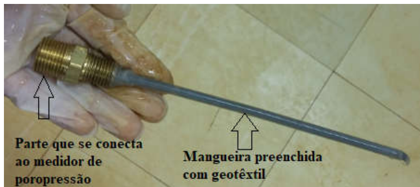
Figura 3.30. Mangueiras para medição de poropressão pelo transdutor.
