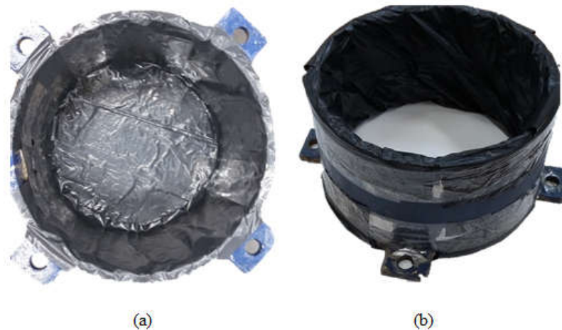
Figura 3.36. Cilindro forrado com camadas de plástico para minimizar o atrito lateral. (a) Parte inferior. (b) Parte superior.
