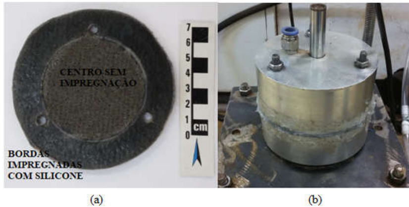
Figura 3.12. Preparação para o ensaio de BBP: (a) Geotêxtil com as bordas impregnadas. (b) Célula revestida com silicone.
