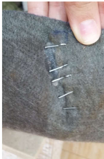
Figura 3.41. Grampos e silicone para unir os cortes.
