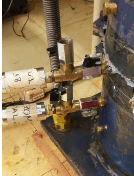
Figura 3.32. Medidores de poropressão conectados ao cilindro.
