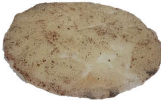
Figura 4.17. Penetração dos grãos de brita moldada com parafina no ensaio C(24)-400.
