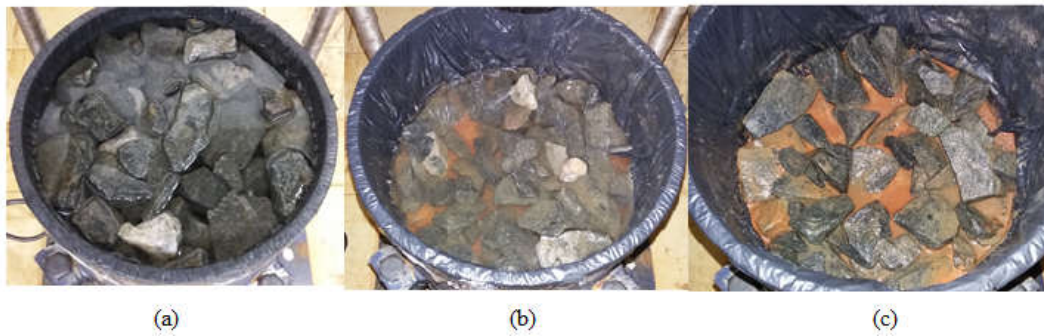
Figura 4.4. Desmonte do ensaio C(27)-SG: (a) Britas e água no topo da camada sem a presença de finos; (b) Nas proximidades do solo do subleito ainda percebe-se que não há presença de finos na água; (c) Britas que penetraram no solo do subleito e ausência de finos nas laterais do cilindro, bem como nas partes expostas das britas.
