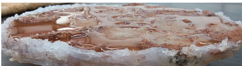
Figura 4.25. Molde de parafina do ensaio C(27)-SG com água.
