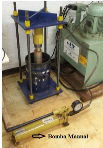
Figura 3.39. Compactação do solo do subleito.
