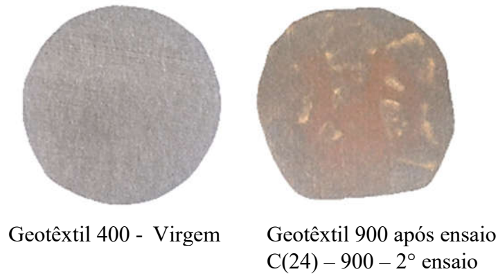
Figura 4.15. Imagens do geotêxtil de 900 g/m 2 nas duas condições.
