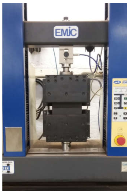
Figura 3.16. Corpo de prova na máquina para ensaio de tração.
