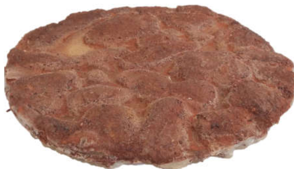
Figura 4.21. Penetração dos grãos de brita moldada com parafina no ensaio C(27)-400.
