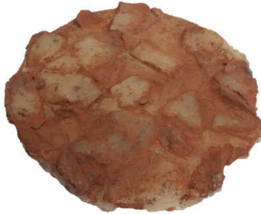
Figura 4.22. Penetração dos grãos de brita moldada com parafina no ensaio C(27)-SG.
