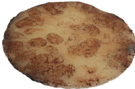
Figura 4.18. Penetração dos grãos de brita moldada com parafina no ensaio C(24)-700.
