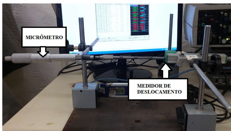
Figura 3.27. Calibração do medidor de deslocamento linear.
