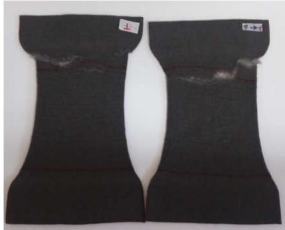
Figura 3.17. Corpos de prova com rompimento nas garras.
