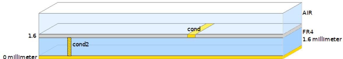
Figura 2.11: Representação do substrato utilizado. Apesar do tangente de perdas igual a 0,022 ser relativamente alto para altas frequências, optou-se por FR-4 de 1,6 mm de camada dupla devido ao baixo custo e facilidade de encontra-lo a venda.
