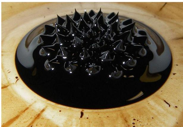
Figura 2.6: A ação de um campo magnético externo modela o fluidomagnético.(Autor: Steve Jurvetson, Flickr).
