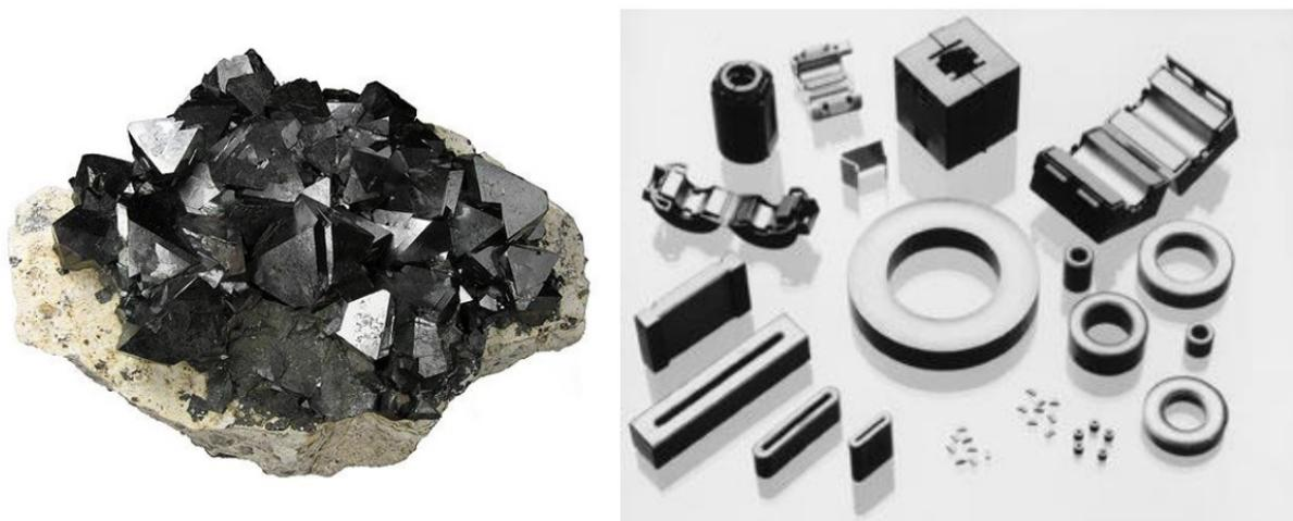
Figura 2.10: À esquerda, a forma que a magnetita,  $Fe_3O_4$ , é encontrada na natureza. À direita, dispositivos eletrônicos que utilizam esse material em diversos aparelhos. Adaptação de [3].
