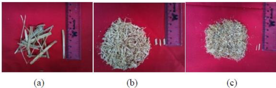
Figura 14: Dimensão partículas. a) Lã: 50 mm de comprimento, 0,2 a 0,5 mm de espessura e 3 a 4 mm de largura; b) Médias: largura de 2 a 3 mm, espessura de 0,5 mm e comprimento de 10 mm; c) Finas: Retidas na peneira de malha de 10 mesh;
