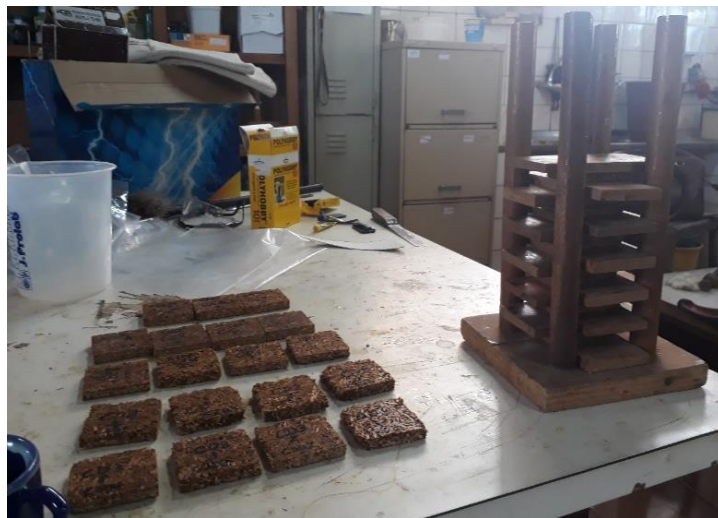
Figura 57: Corpos de prova sendo preparados para cura do adesivo em prensa manual. Fonte: Acervo pessoal.
