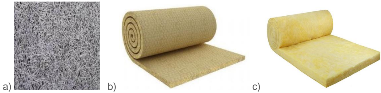
Figura 3: a) Painel de fibra de madeira; b) Lã de rocha; c) Lã de vidro. Fonte: a) knaufamf (2018) b) Refratil (2018) c) Refratil (2018).
