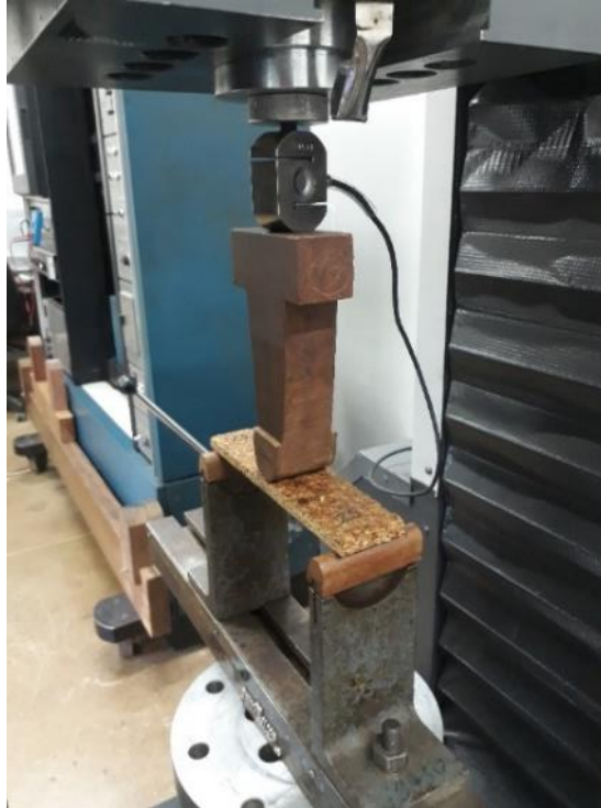
Figura 59: Ensaio de Flexão Estática. Fonte: Acervo Pessoal.
