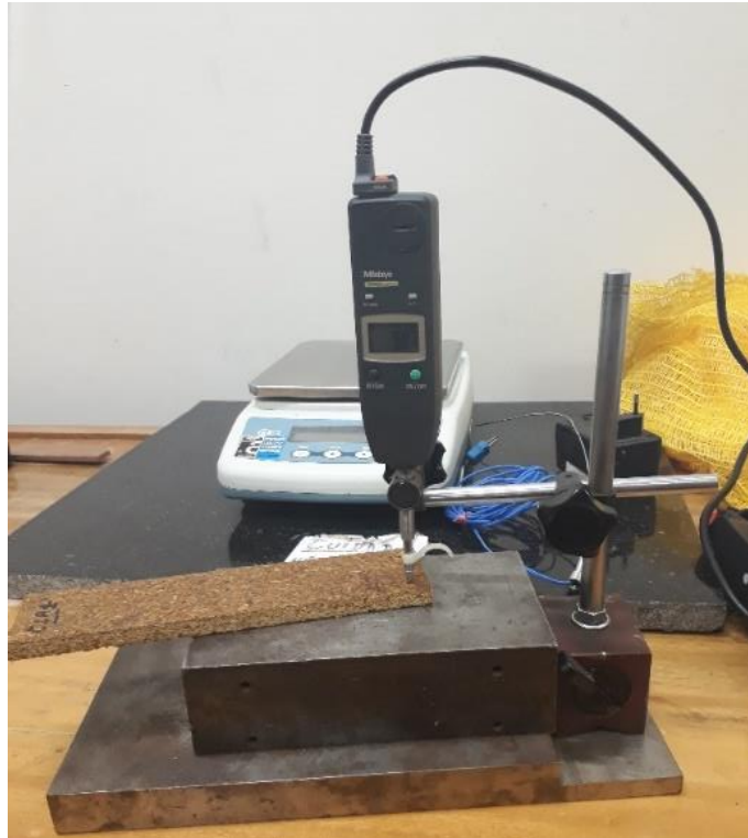
Figura 55: Aferição de medidas dos corpos de prova com micrômetro. Fonte: Arquivo pessoal.
