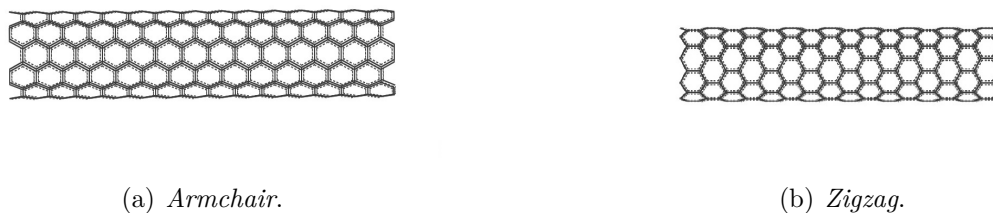
Figura 4 – Diferenças de nanotubos armchair e zigzag .
