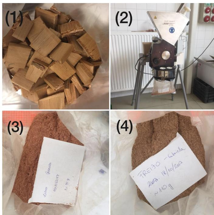
O teor de umidade foi determinado em triplicata para cada espécie. Três frascos com 2g de serragem foram pesados antes e após irem para a estufa à  $105^{\circ}\text{C} \pm 2^{\circ}\text{C}$  por 24 horas e serem resfriados a temperatura ambiente.
