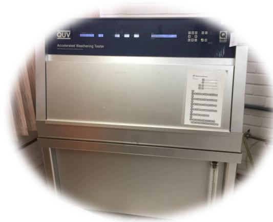
A câmara possui controle automático de temperatura e umidade relativa, utilizando lâmpadas fluorescentes UVA com irradiância de  $1,36 \text{ W/m}^2/\text{nm}$  a  $340\text{nm}$  (Figura 9), conforme a norma ASTM G154 (ASTM, 2006).
