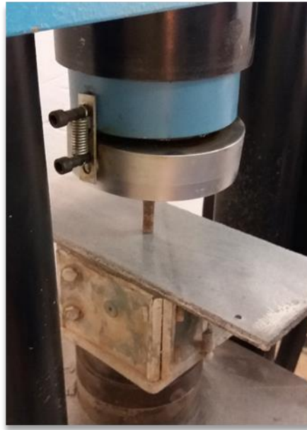
Figura 31 – Aplicação da carga pontual para fissuração das placas
