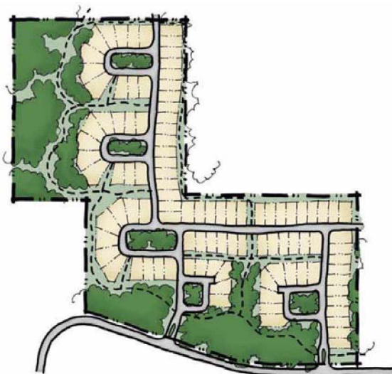
Figura 3.10 - Layout híbrido entre grelha e curvilíneo com a inserção de espaços abertos. Fonte: HINMAN, 2012
