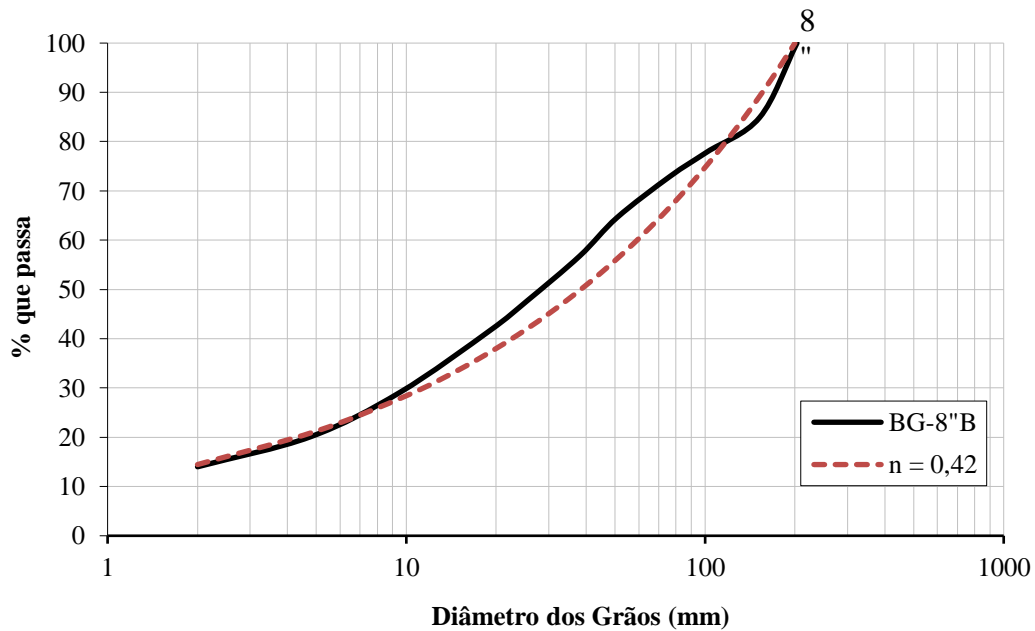
Figura 3.15 - Curva granulométrica adotada nos ensaios com a biotita gnaisse de Peixe Angical.
