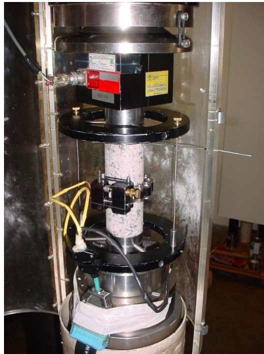
Figura B. 9 – Equipamento utilizado nos ensaios de compressão uniaxial em rocha.
