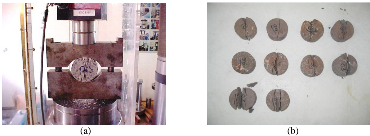
Figura B. 8 – Ensaio de compressão diametral: a) Mordentes curvos aplicando carga sobre disco do granito de Serra da Mesa; b) Corpos de prova ensaiados com a brecha basáltica de Campos Novos.
