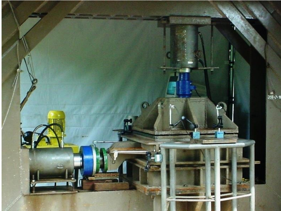
Figura 3.27 – Equipamentos montados para realização de ensaio de cisalhamento direto de grandes dimensões.
