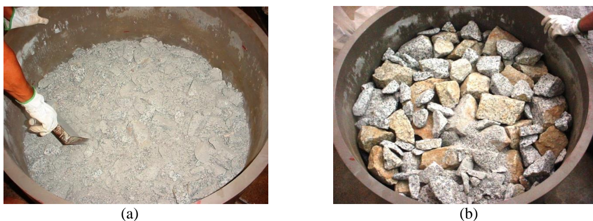
Figura 3.17 – Ensaio para determinação das densidades máximas e mínimas: (a) Espalhamento de material da curva Gr-3''B para determinação da densidade mínima; (b) Material arrumado da curva Gr-8''B para determinação da densidade máxima.
