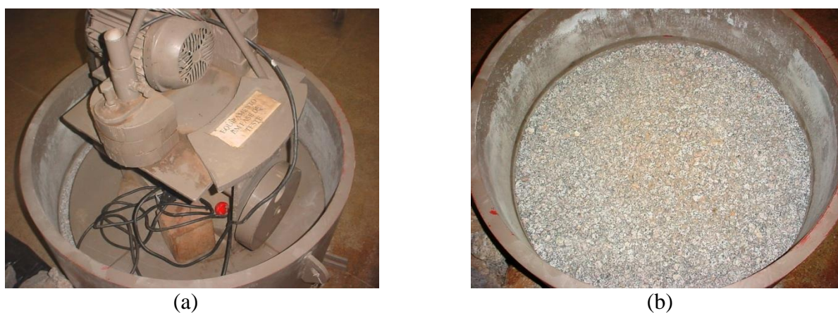
Figura 3.16 – Equipamento para ensaio de compactação: (a) Placa vibratória colocada dentro do molde de compactação; (b) Aspecto do material da curva Gr-1''B após compactação dentro da câmara rígida.
