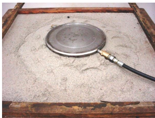
Figura 3.23 – Célula de pressão total.
