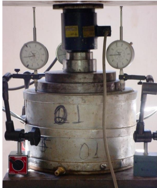
Figura 3.25 – Equipamentos para ensaio de compressão unidimensional com a D_{c30R} .
