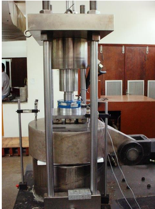
Figura 3.28 – Equipamento servo-controlado para ensaios de cisalhamento direto.
