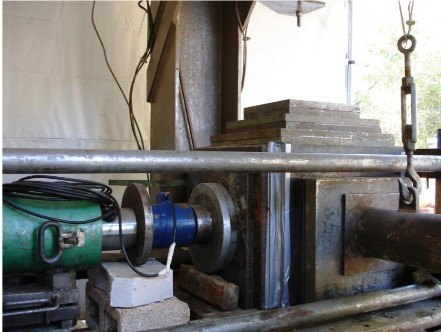
Figura 3.30 – Detalhes da montagem da caixa triaxial e fechamento lateral com fita adesiva.
