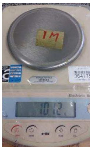
Figura 36: Pesagem da amostra a 0% de umidade
