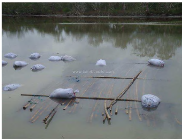
Figura 72: Detalhe do tratamento por imersão em água com alta concentração de sólidos suspensos.
