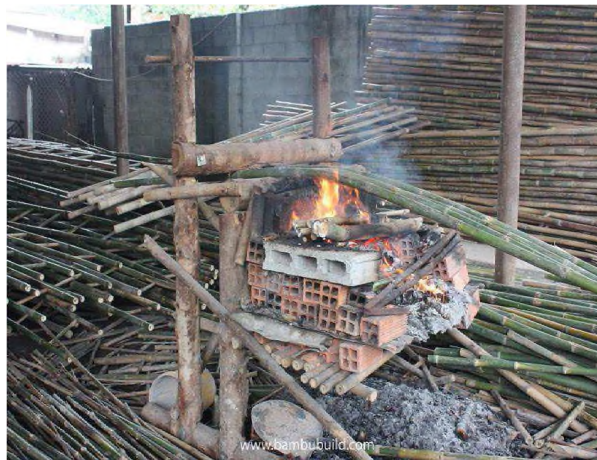
Figura 68 Aquecimento com fogo para viabilizar a curvatura da vara.
