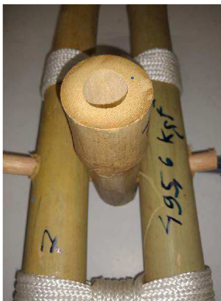
Figura 90: Ruptura do pino de madeira nos ensaios da ligação perpendicular
