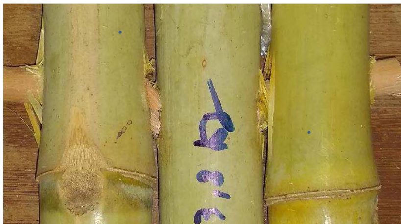
Figura 89: Detalhe da ruptura do pino
