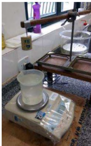
Figura 37: Imersão em água para determinação do volume da amostra
