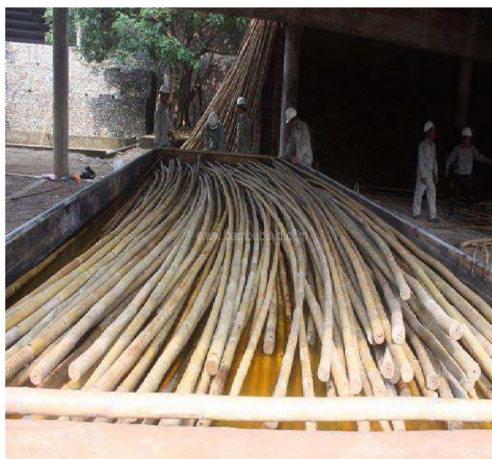
Figura 71: Detalhe do tratamento por imersão em tanque.
