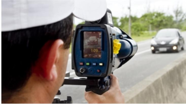
**Figura 2.5** Medidor de velocidade portátil
