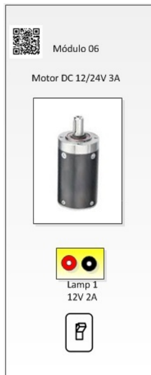
Figura 2.37: Módulo 06 - Motor DC 12/24VDC 3A
