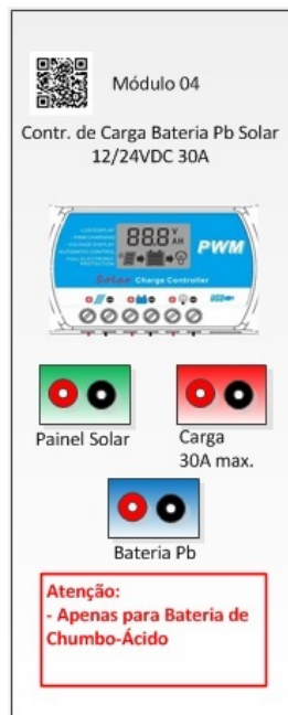
Figura 2.31: Módulo 04 - Controlador de carga solar - Pb 12/24VDC 30A
