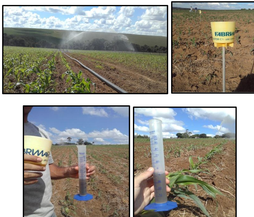
Figura 4: Ensaios de uniformidade com a instalação de pluviômetros e aferição do volume de efluente coletado para determinação das doses a serem aplicadas.
