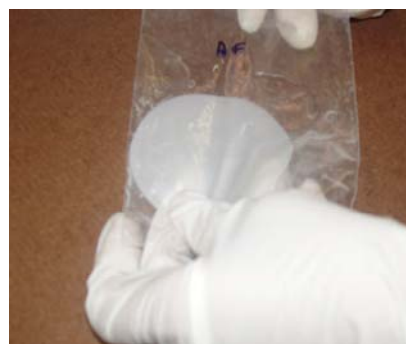
Figura 4.16 – Lavagem da membrana
