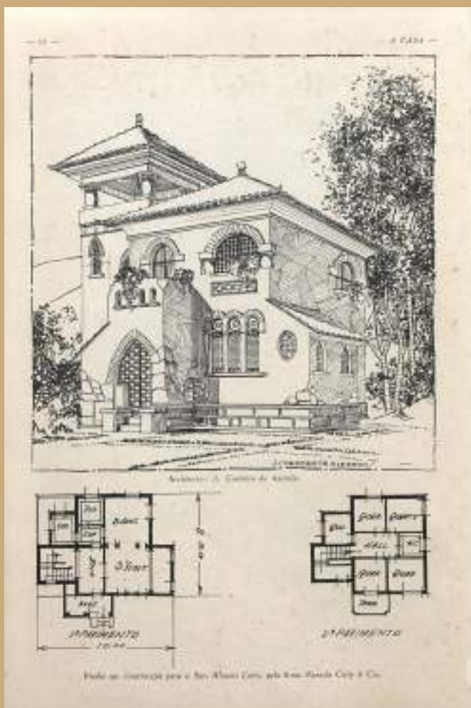
Figura 192: Residência com elementos florentinos, nota-se a torre elevada em relação ao telhado e as janelas em arco pleno. Projeto de J. Cordeiro de Azeredo. Fonte: A CASA. Rio de Janeiro, n. 09, jan. 1925, p. 12.
