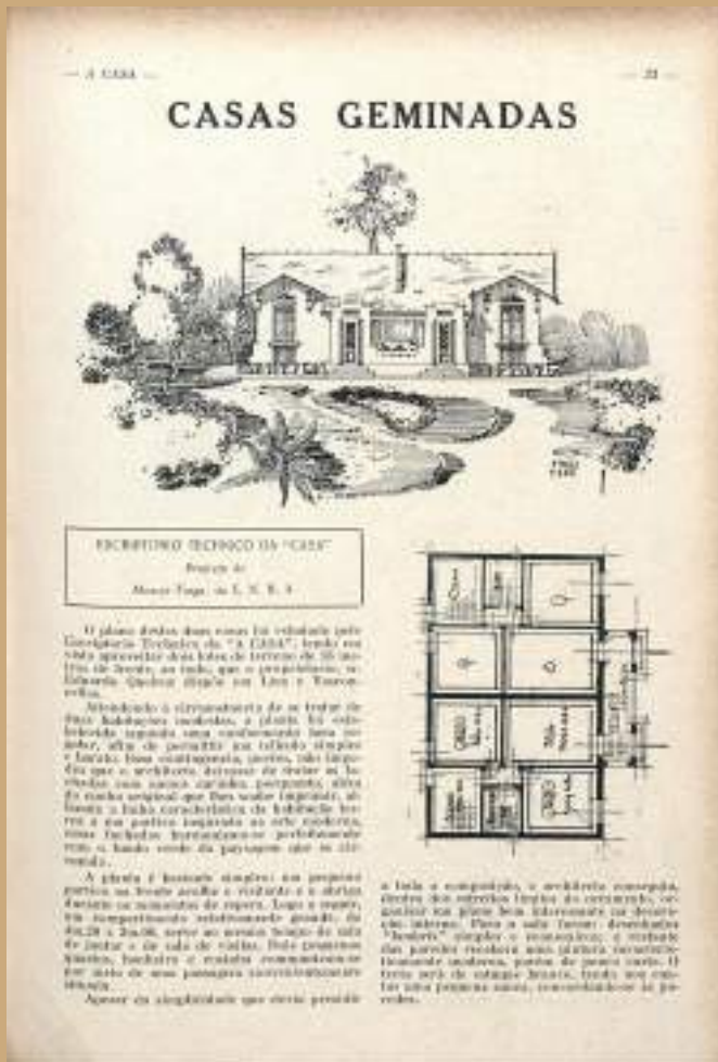
Figura 165: Projeto de habitação geminada, de autoria de Moacyr Fraga. Neste exemplar nota-se que a planta foi bem resolvida, pois agenciou de maneira eficiente os ambientes, contemplando separação de fluxos e garantindo a todos ambientes iluminação e ventilação diretas. Quanto à fachada, um corpo avança, gerando um alpendre e formando um pórtico “inspirado na arte moderna”. Fonte: A CASA. Rio de Janeiro, n. 52, ago. 1928, p. 32.
