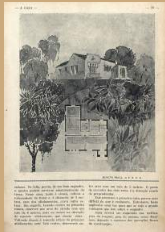
Figura 114: Bungalow Misiones. Exemplar característico, com várias aberturas guarnecidas por gradis metálicos, além de mesclar trechos de telhado aparente com platibandas. Fonte: A CASA, n. 60, abr. 1929, p. 33.
