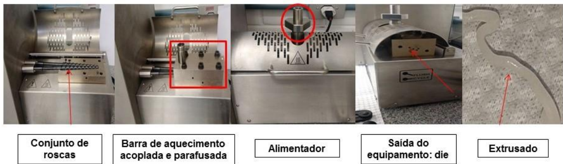
Figura 4 – Imagem esquemática da termoextrusora HaakMiniCTW (ThermoScientific®, Netherland) – escala laboratorial (Laboratório de Tecnologia de Medicamentos, Alimentos e Cosméticos – LTMAC)
