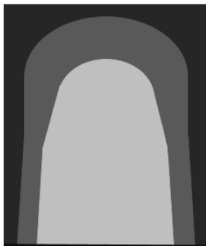
Figura 2.1 - Parábola de molhagem de fachadas de edifícios pela ação da chuva dirigida (STRAUBE, 1998)
