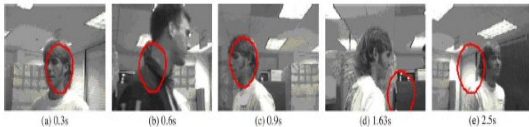
Figura 2.6: Rastreamento de contorno de cabeça em movimento pelo algoritmo de rastreamento baseado em filtro de Kalman descentralizado [41].
