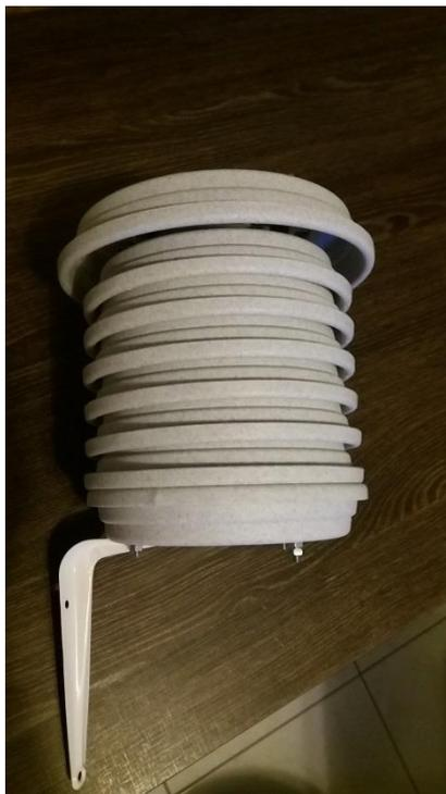
**Figura 3.1 Estação meteorológica usada no projeto Clima Escola**
