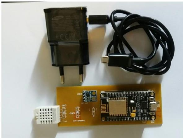
**Figura 3.2 Placa de circuito usado na Estação Meteorológica**
