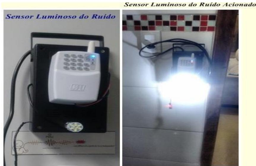
**Figura 15. Protótipo do Sensor Luminoso instalado**
