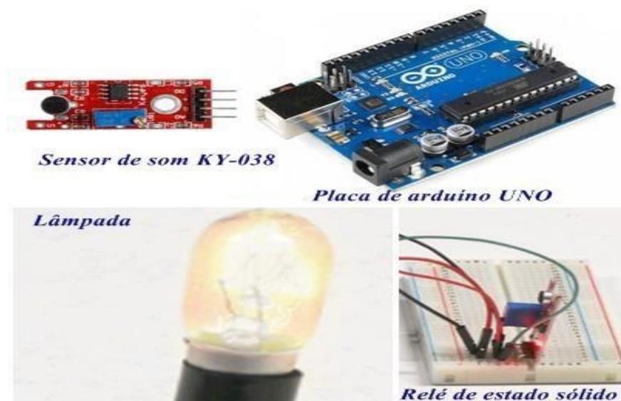
**Figura 14.** Componentes que fazem parte da montagem do Protótipo
