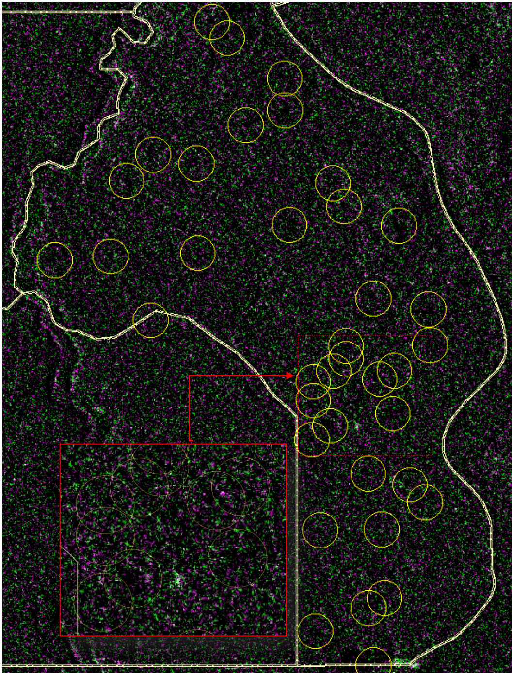
Figura 38: Detalhe do resultado do processamento da diferença entre os anos de 2016 e 2011 na FLONA de Jacundá para realçar áreas sob exploração seletiva de madeiras em uma imagem RGB.
