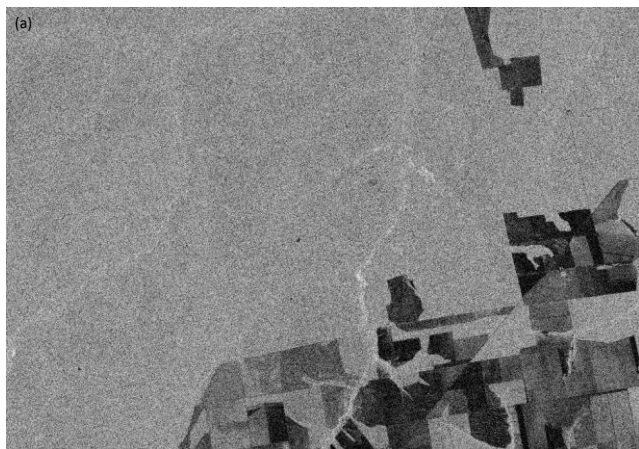
Figura 32: Resposta visual para cada polarização na área da Fazenda 4 Ventos, no estado de Mato Grosso. As figuras (a), (b) e (c) representam a polarização HH para 2015, 2016 e 2017, respectivamente. As figuras (d), (e) e (f) representam a polarização HV para 2015, 2016 e 2017, respectivamente.
