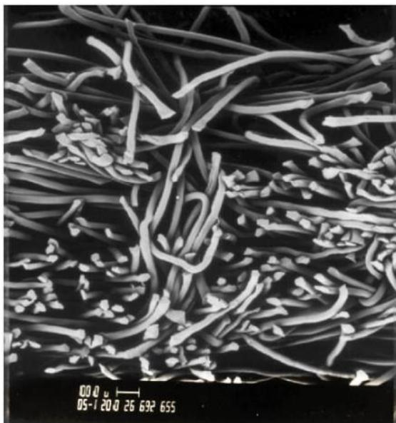
Figura 2.6: Fotomicrografia (ampliada 40x) do entrelaçamento da estrutura de fibras formadas pelo processo de *needle-punching* (Bhatia & Smith, 1996a)
