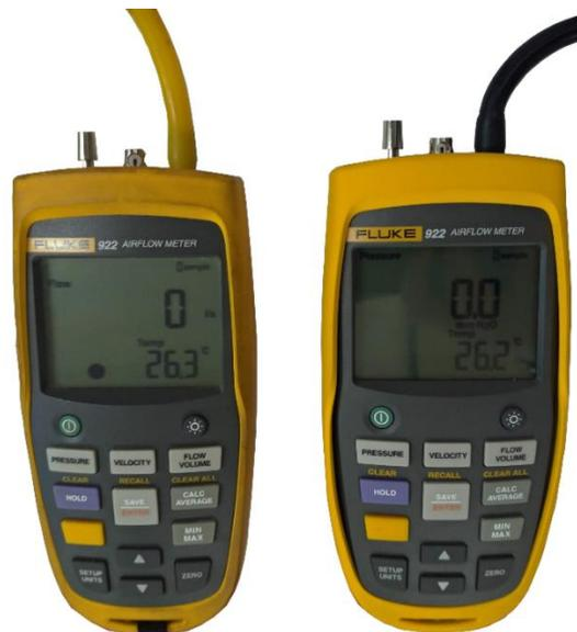
Figura 3.3: Fluxômetros utilizados no ensaio de ponto de bolha (BBP)
