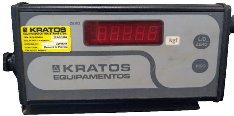
Figura 3.10: Leitor digital de cargas utilizado nos ensaios
