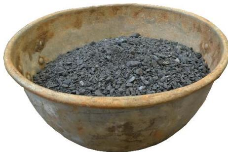
Figura 3.1: Brita utilizada no ensaio de ponto de bolha (BBP)
