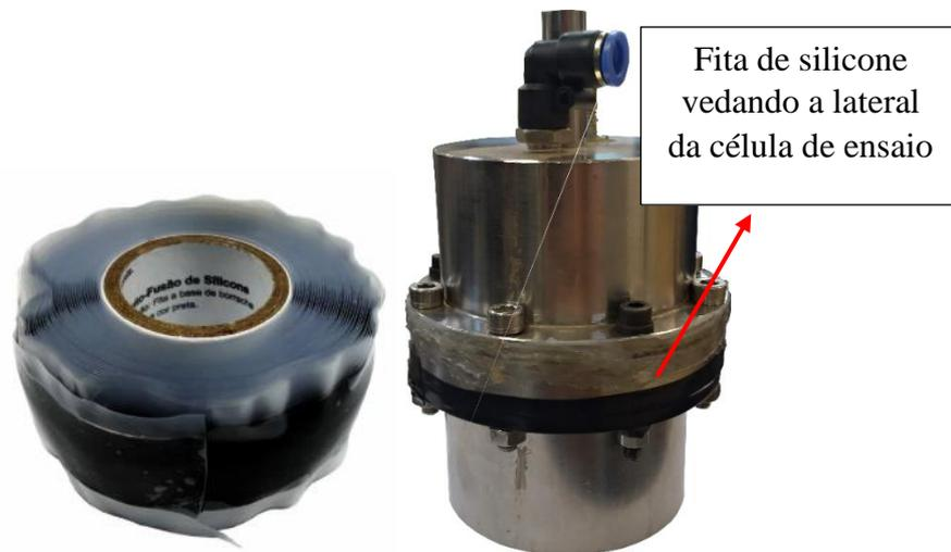
Figura 3.7: Fita de silicone utilizada para vedar a lateral da célula de ensaio
