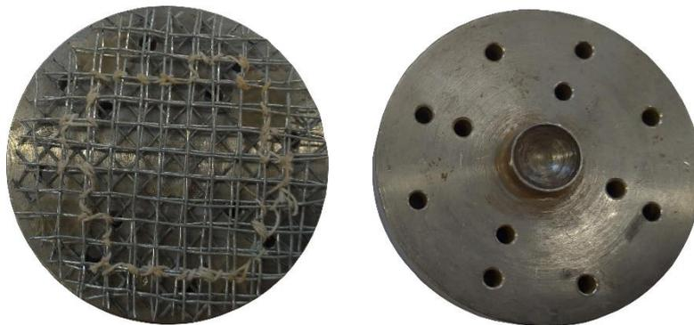
Figura 3.9: Prato de transmissão de compressão interno à célula de ensaio
