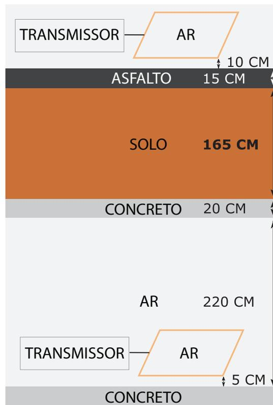
Figura 8.1: Cenário para comunicação TTE. Representação do meio ambiente entre túnel subterrâneo e estacionamento na RU/UNB [11].
