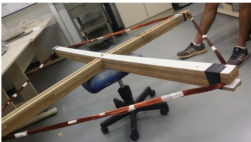
Figura 5.4: Foto da segunda antena desenvolvida pelo projeto, no formato quadrado, com 4,9 Kg de cobre, fio AWG 11 e área de 1,72 *m*<sup>2</sup>
