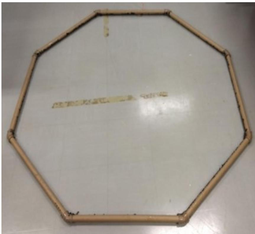
Figura 5.5: Foto da terceira antena desenvolvida pelo projeto, no formato octogonal, com 2,97 Kg de cobre, fio AWG 11 e área de  $2,43 m^2$
