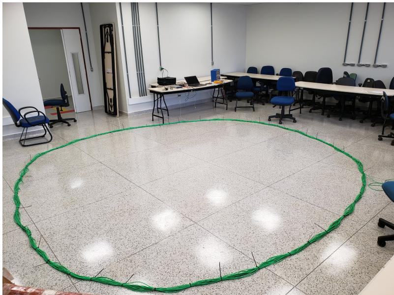
Figura 5.9: Foto da última antena desenvolvida pelo projeto, no formato circular, em que buscou-se otimizar o amplificador, utilizou-se cabo flexível de  $6 \text{ mm}^2$  utilizando-se  $240 \text{ m}$  de fio e área de  $19,63 \text{ m}^2$
