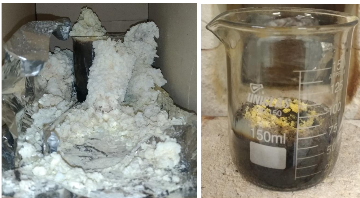
Figura 10: Resultado da secagem ao forno da resina polimérica para as amostras a) PE-1,5% b) PE-5%
