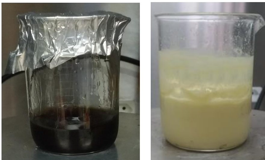
Figura 9: Material obtido ao fim da secagem de líquidos do processo Pechini
