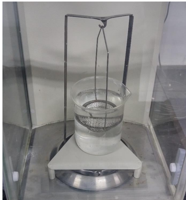
Figura 15: Aparato para medição do peso aparente das amostras sinterizadas
