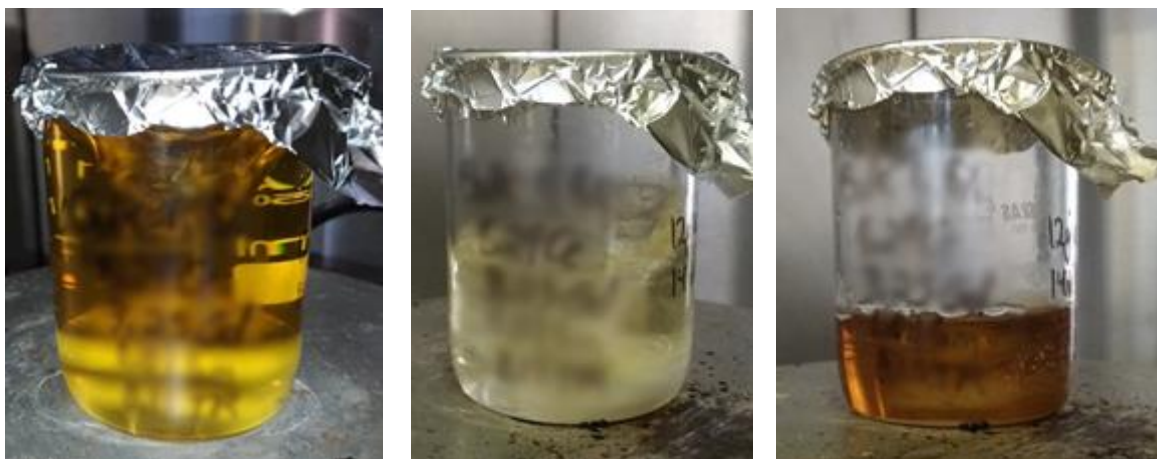
Figura 8: Variação das características durante a secagem de líquidos do processo Pechini
