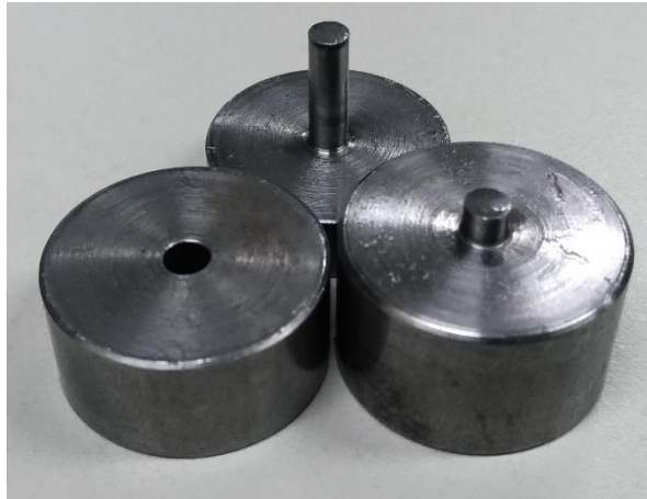
Figura 13: Matriz metálica utilizada para conformação de pellets
