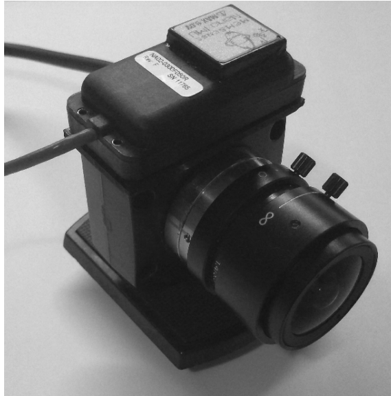
Figura 4.1: Montagem dos sensores utilizados na realização do experimento. Tem-se uma câmera Firefly FMVU-03MTM/C global shutter com a UMI Memsense Nano IMU fixamente acoplada ao corpo da câmera.
