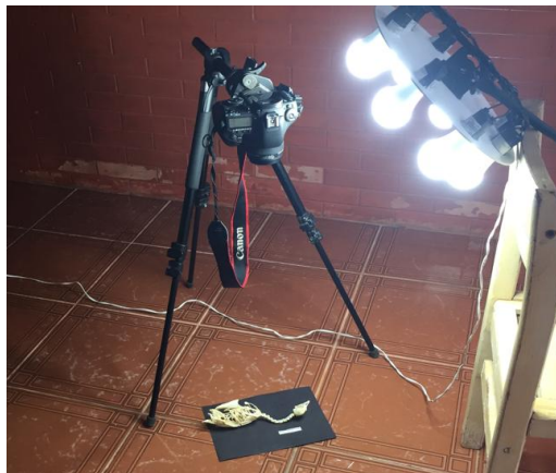
Figura 8- Iluminador caseiro produzido com 8 lâmpadas LED de 8,5W para fotografias do esqueleto de frango. Fonte: Própria.
