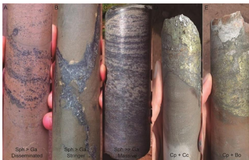
Figura 2. 4 - a) Mineralizações do sistema Zn/Pb com predomínio de esfalerita disseminada; b) Mineralizações do sistema Zn/Pb com predomínio de esfalerita stringer; c) Mineralizações do sistema Zn/Pb com predomínio de esfalerita maciça; d) Mineralizações do sistema Cu com calcopirita e calcocita; e) Mineralizações do sistema Cu com calcopirita e bornita.
