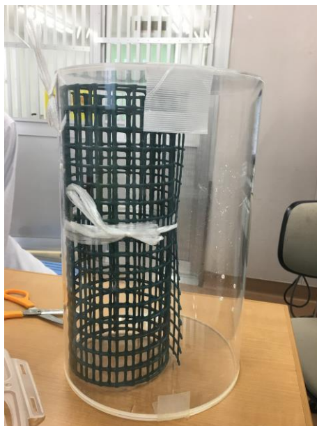
Figura 15. Caixa acrílica colocada dentro aparato de raio-x para filmagem do animal com rede plástica internamente para conter os movimentos do animal e mantê-lo em posição vertical durante os 5 minutos de filmagem.
