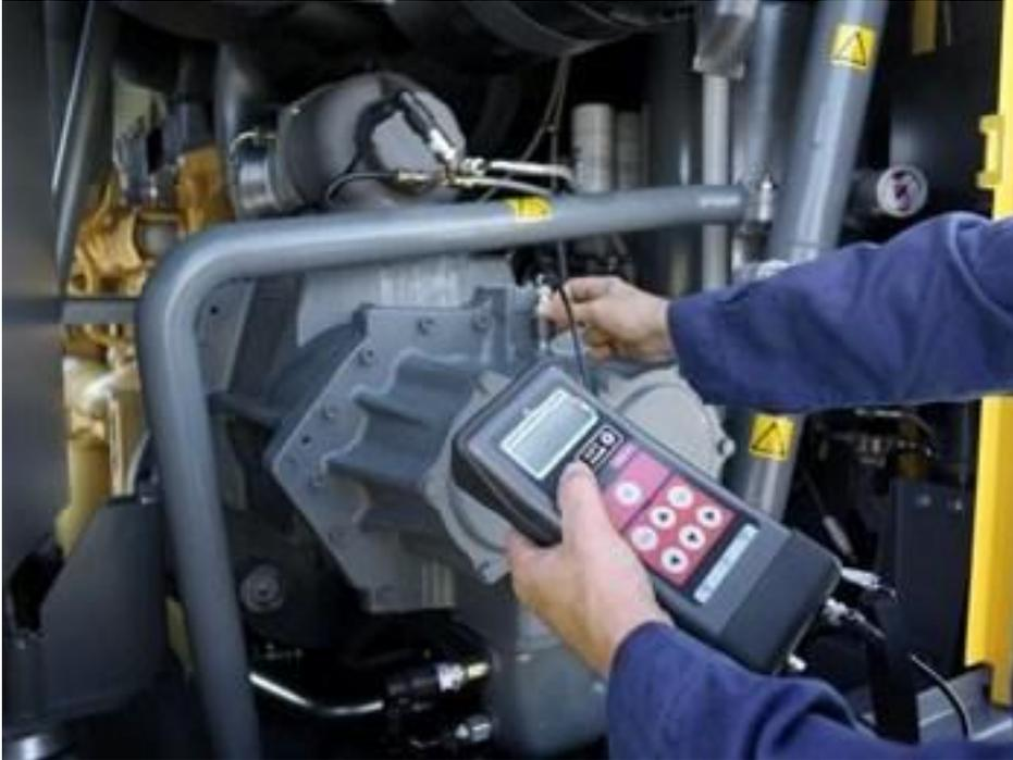
Figura 1 - Coleta e análise de vibrações - fonte: internet
