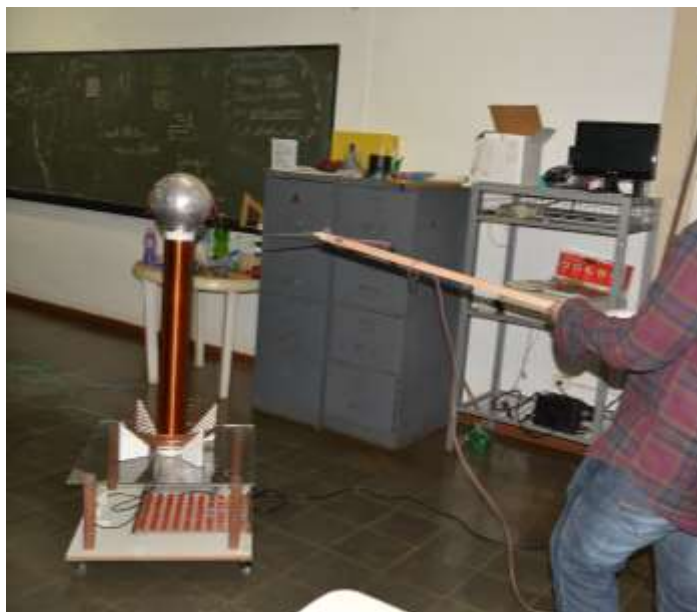
Figura 43- Detecção do campo elétrico através da antena linear Fonte: Arquivo pessoal
