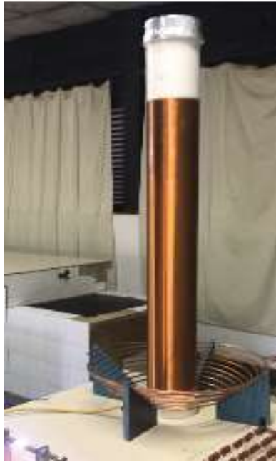
Figura 17- Bobinas primária e secundária Fonte: Arquivo pessoal
