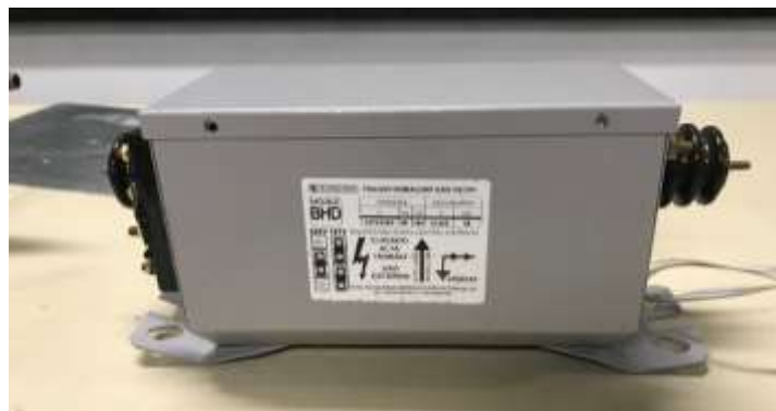
Figura 14- Transformador Gás neon de 12kV usado no artefato Fonte: Arquivo pessoal
