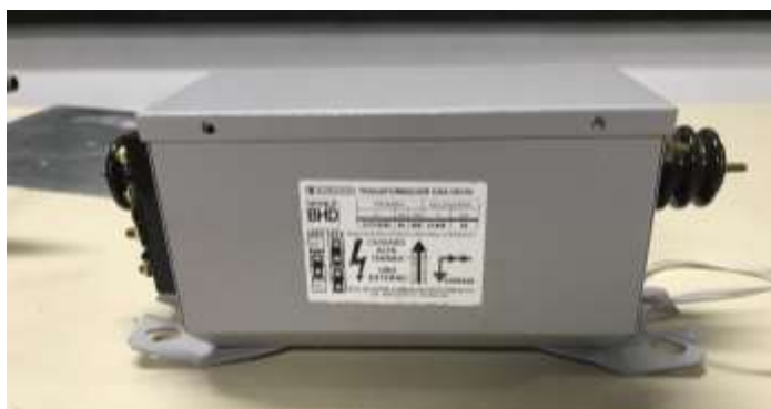
Figura 12- Transformador Gás neon de 12kV usado no artefato. Fonte: Fotografia da autora.
