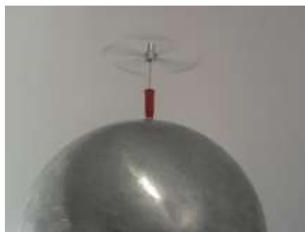
Figura 32- Cata-vento elétrico em movimento no Gerador Fonte: arquivo pessoal
