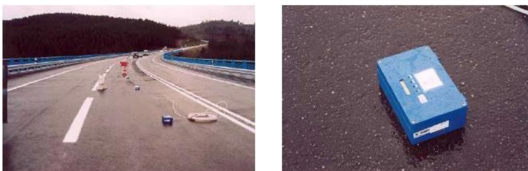
Figura 4.5 – Esquema de aquisição com acelerômetros sem fio (MAGALHÃES, 2004).
