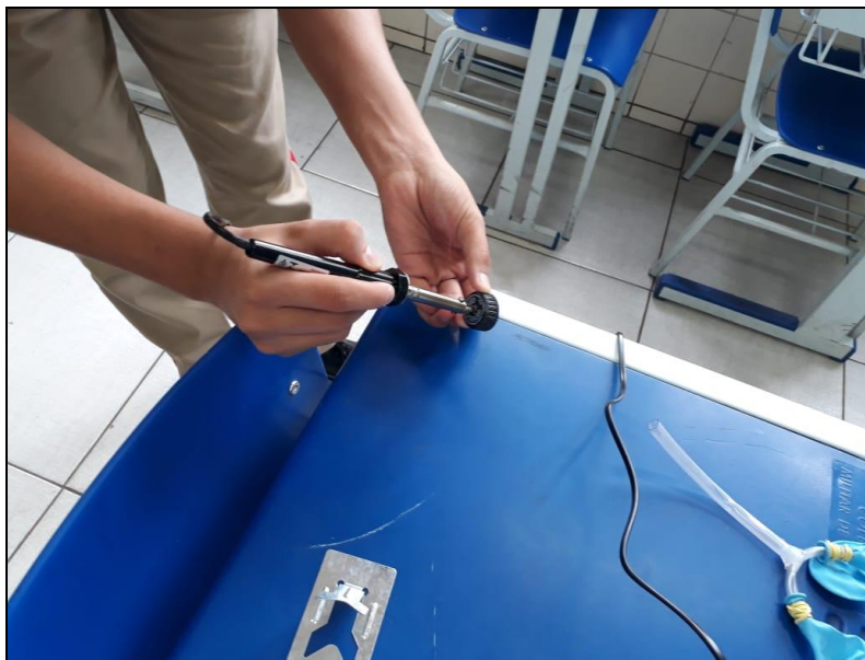
Figura 31- Aluno fazendo um furo na tampa da garrafa PET com ferro de solda. Fonte: própria.
