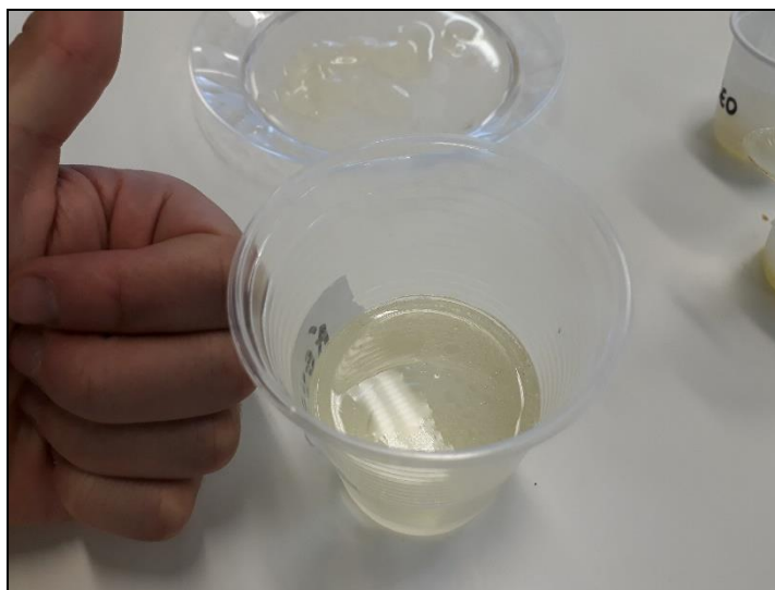
Figura 20- Formação de várias gotículas de óleo após a adição do detergente. Fonte: própria.
