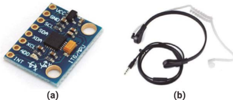
Figura 6.2. Equipamentos utilizados para aquisição de dados. a) Placa de acelerômetro e giroscópio b) Microfone de alta precisão.
