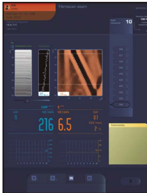
Figura 8.5. Exemplo de imagem exibida pelo Fibroscan® de um tecido hepático humano. Note a imagem no modo A (à esquerda), o sinal ultrassônico retroespalhado pelo tecido em função do tempo (central) e um mapa da propagação da onda de cisalhamento com a reta indicativa da frente de onda (à direita). Abaixo das imagens, observamos o valor do CAPTM (216 dB/m) e a mediana do módulo de Young (6,5 kPa)
