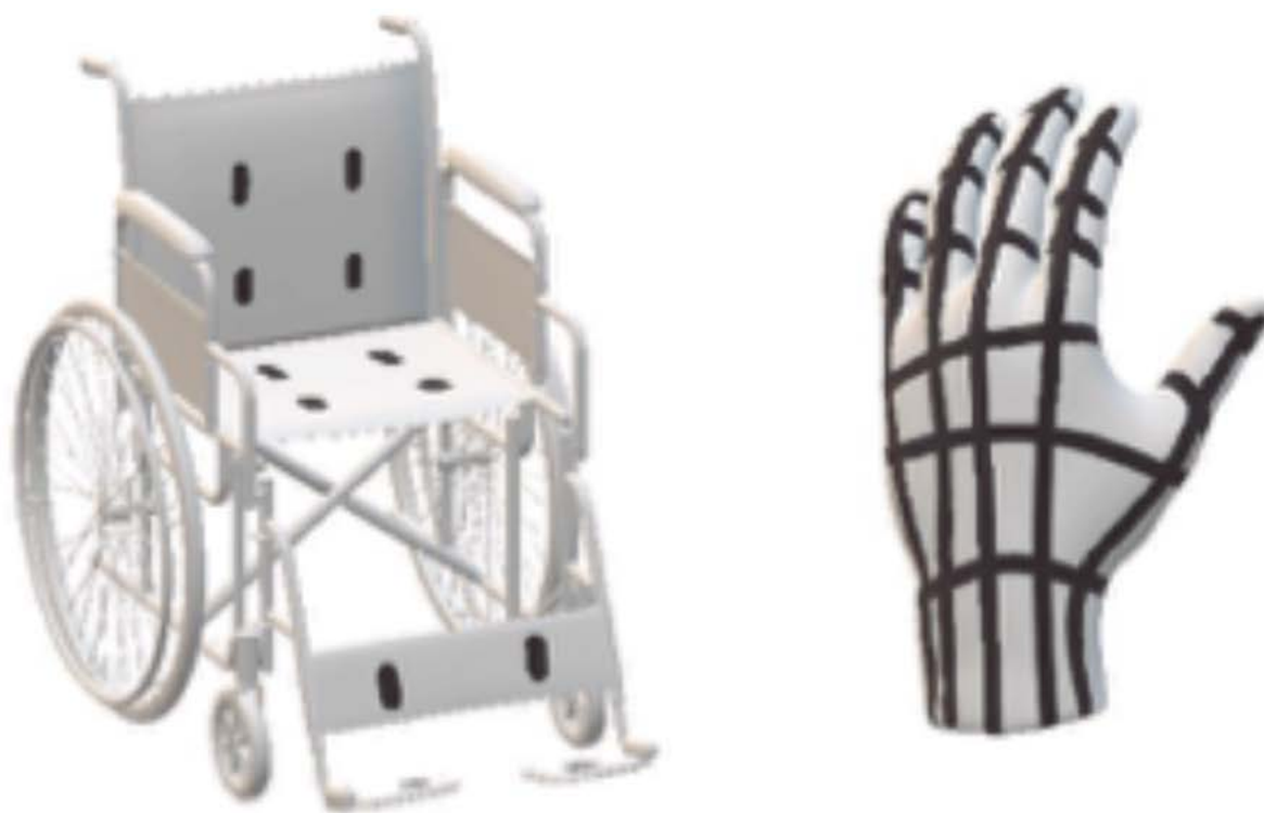
Figura 2.2. Utilização de sensores de força resistivos em cadeira de rodas e prótese de membro superior.
