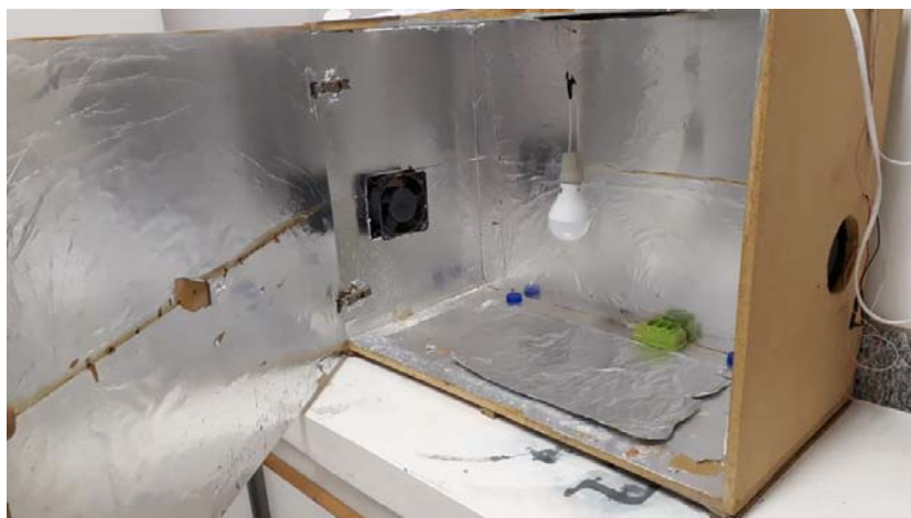
Figura 79: Câmara utilizada nos testes de degradação forçada com luz
