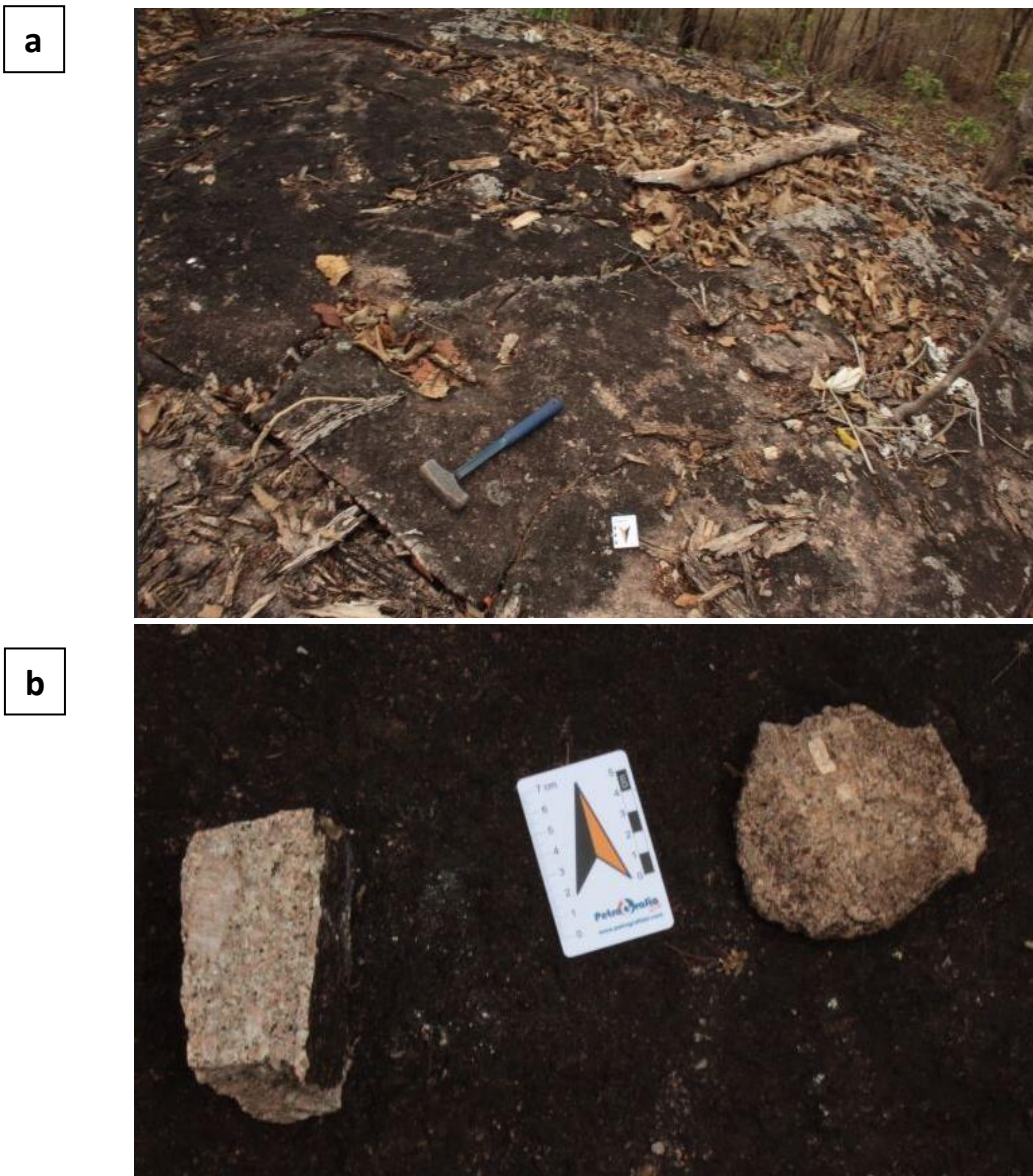
Figura 3.16: (a) Lajedos do Granito Serra Verde. (b) Blocos do granito apresentando cristais centimétricos de Feldspato Potássico.
