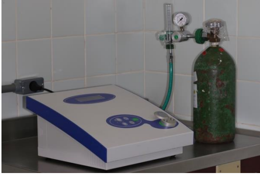
Figura 5 – Gerador de O3 medicinal e cilindro de oxigênio medicinal
