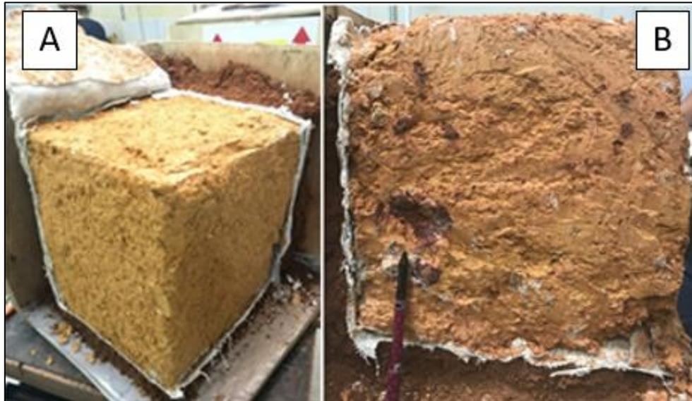
Figura 3.1 – Amostra indeformada de estéril: (a) coletada na pilha; (b) coletada no aterro.
