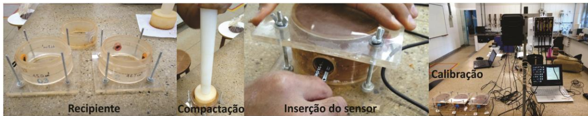
Figura 4.7. Etapas do processo de calibração dos sensores de umidade, Decagon EC-5.
