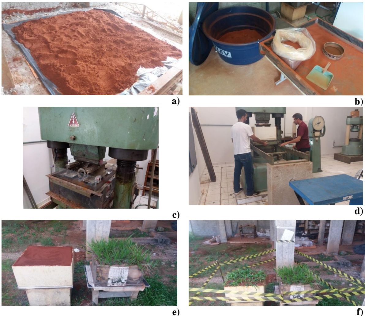
Figura 6.2. Etapas de preparação e compactação estática das amostras de solo com e sem vegetação a) secagem ao ar até umidade hidrocópica de 5%; b) peneiramento (#2,0), quarteamento e homogeneização do solo para umidade de 18% (de 10 em 10 kg); c) compactação estática de amostras para solo exposto, caixa acrílica e acessórios; d) compactação estática de amostras para solo com vegetação, caixa em madeirite; e) plantio das espécies de gramíneas utilizadas e f) amostras prontas para ensaio no simulador de chuva.
