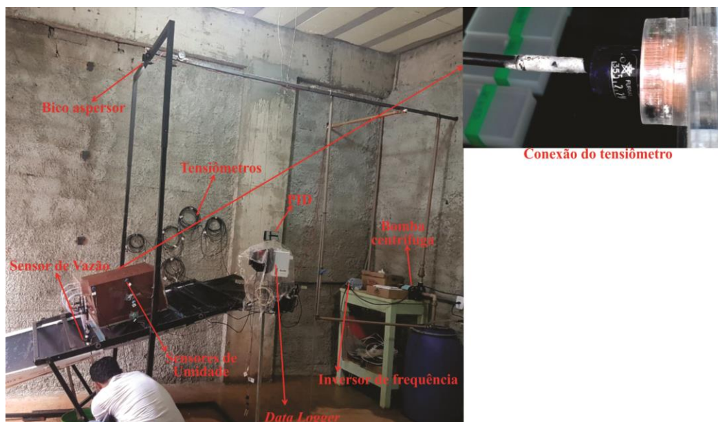
Figura 4.15. Projeto completo do SC com destaque para o módulo geração de chuva e monitoramento (ensaio realizado com 15° de inclinação para amostra com solo exposto).
