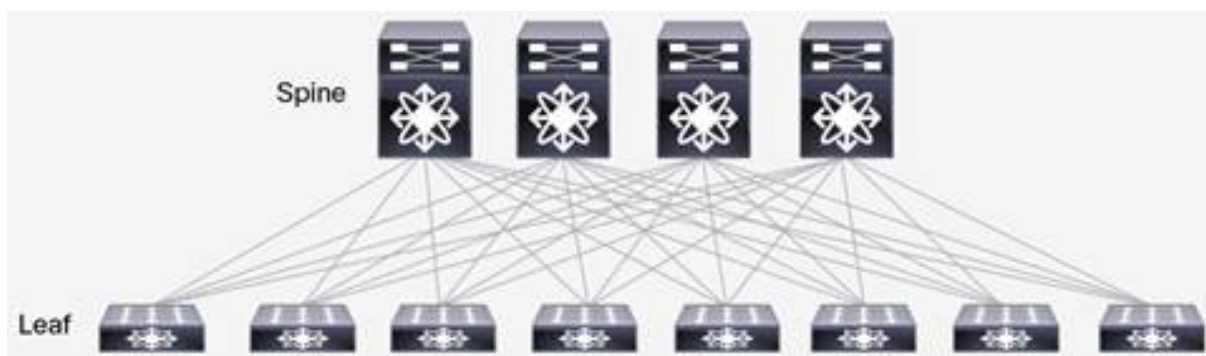
Figura 2.19: Topologia Típica Spine and leaf
