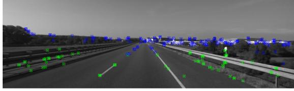
Figura 2.11: Exemplo de uma imagem estéreo sendo rastreada, com os pontos rastreados em destaque (fonte: [6]).
