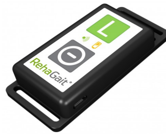
(b) RehaGait: the bluetooth IMU.
