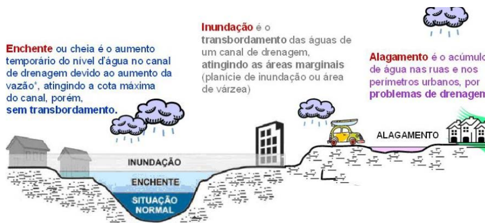
Figura 2.1 - Distinção dos tipos de escoamentos e acúmulo superficial de água (Fonte: dscbcsp.blogspot.com.br e modificado de BATISTA (2014)).
